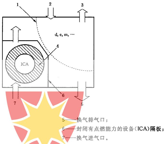
图 F.1 表示采用稀释区域原理来简化换气和稀释试验要求的示意图
